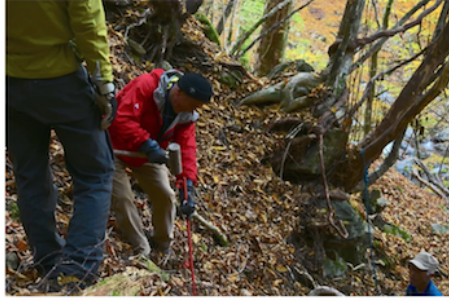
斜面に鉄の杖を打ち込むが、地中の岩に阻まれて杖がなかなか入っていかない。
